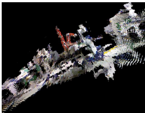
Abbildung 2: Gemeinsam visualisierte Punktwolken aus den Ansichten von vier registrierten Kinect-Kameras; links: Seitenansicht; rechts: Aufsicht
