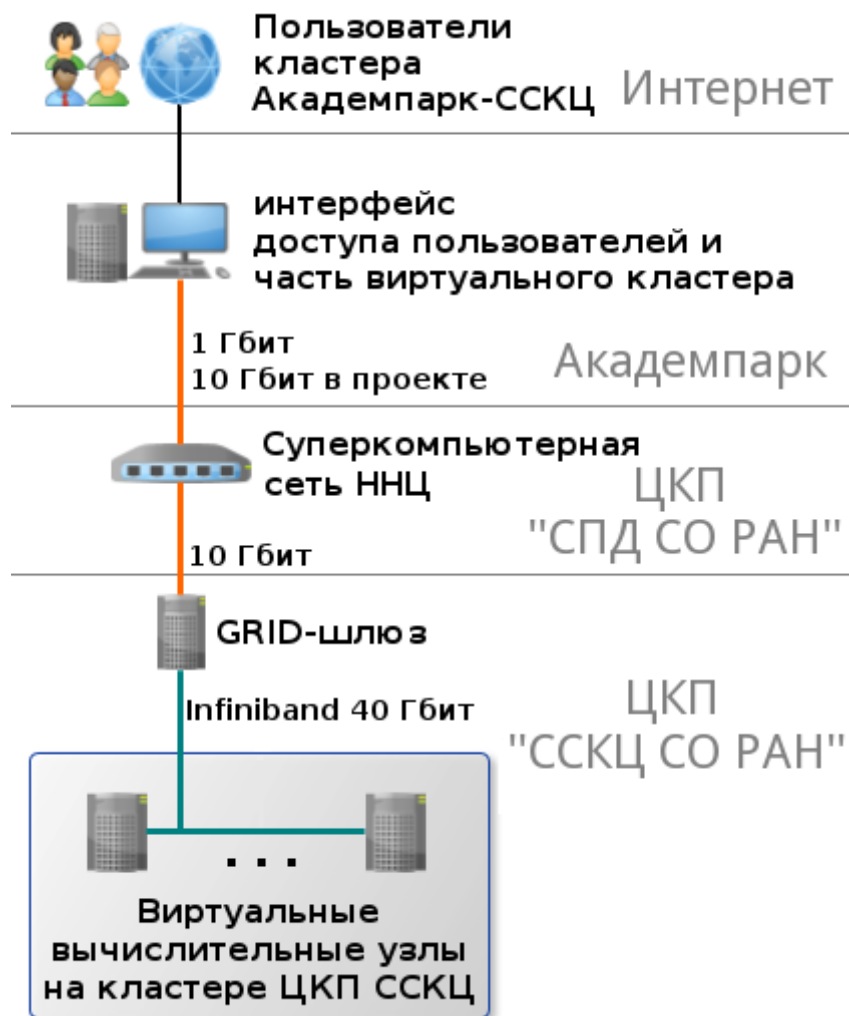
Рис. 8. Схема виртуального кластера Академпарк-ССКЦ
