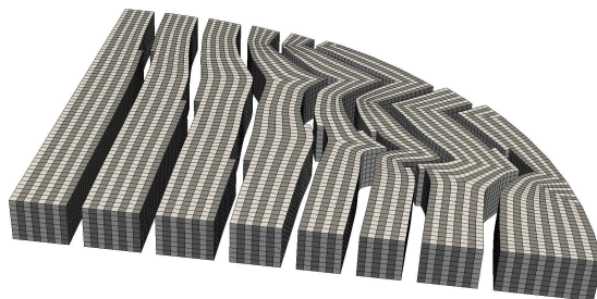
Рис. 2. Подмножества ячеек сетки, полученные при блочном варианте построения.
