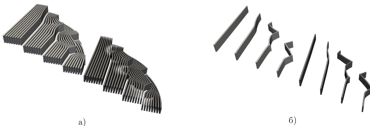
Рис. 3. Нечетно-четный вариант построения подмножеств ячеек: а) группы из восьми слоев, ячейки из которых участвуют в параллельных вычислениях, выполняемых n_p = 8 процессами; б) последовательность слоев сетки, образующих подмножество S_1 , над ячейками которого процесс с номером ноль выполняет сборку q = A_1^T \tilde{q} , здесь A_1^T \subset A^T .
