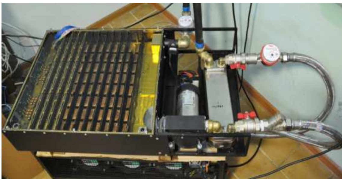
Рис. 5. Опытная эксплуатация технологического образца вычислительного модуля системы «Скат»
