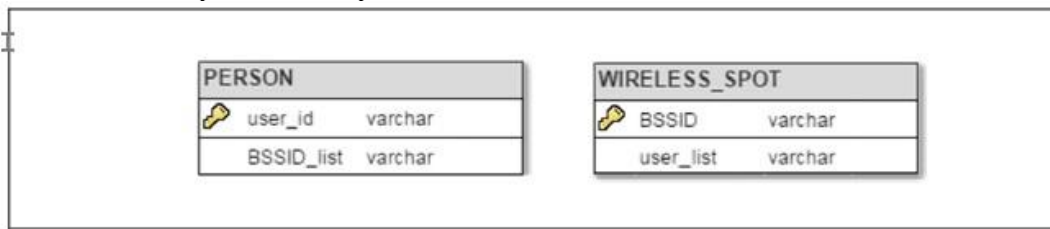
Рис. 6. Схема базы данных, используемая в системе, работающей по схеме В. user_id – идентификатор пользователя, BSSID_list – список беспроводных точек доступа, user_list – строка, содержащая список идентификаторов пользователей, находящихся вблизи беспроводной точки доступа, и строки действия их отметок
