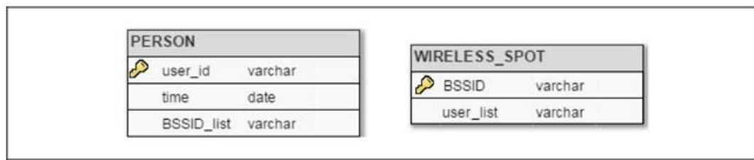
Рис. 5. Схема базы данных для системы геоотметки, работающей по схеме А. user_id – идентификатор пользователя, time – время отметки, BSSID_list – список идентификаторов беспроводных точек доступа, user_list – список идентификаторов пользователей, находящихся вблизи беспроводной точки доступа
