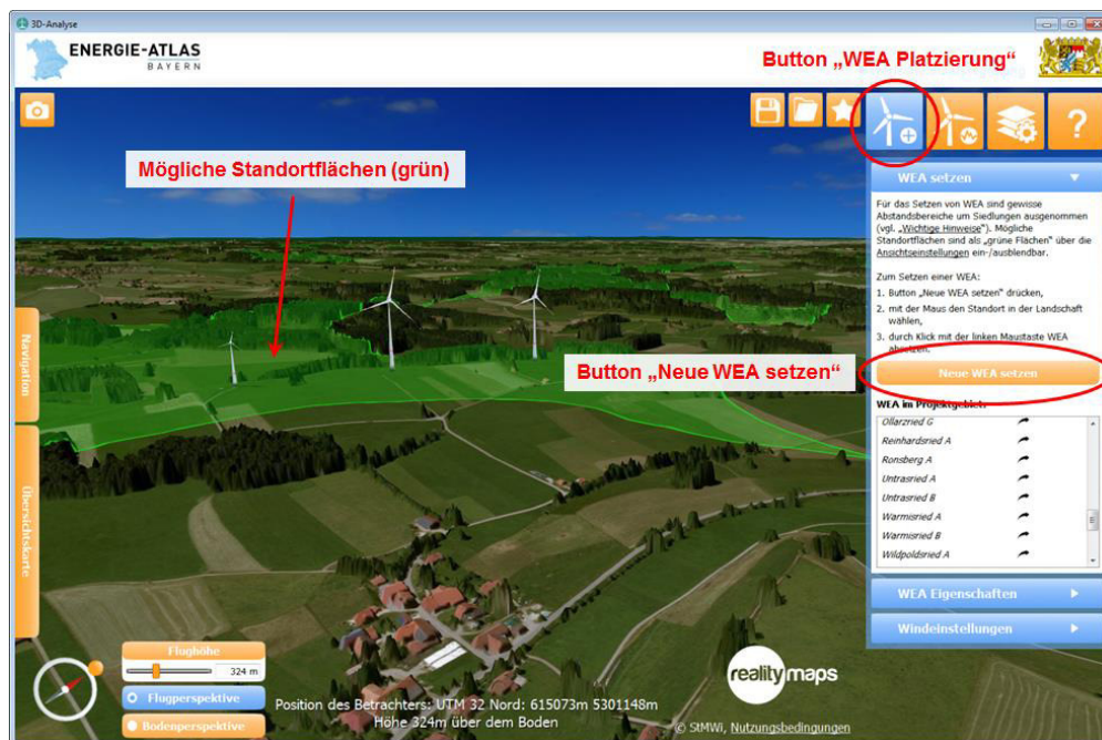
Abbildung 11: Menü zum Setzen von Windenergieanlagen
