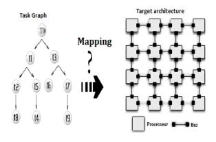
Fig. 3 Mapping de graphe de tache sur architecture NOC
